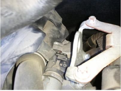
**WARNING:** THERE ARE TWO PLUGS ON COMMON RAIL. MAKE SURE YOU PLUG INTO THE COMMON RAIL ON THE PASSENGER SIDE OF THE ENGINE. DO NOT PLUG INTO THE DRIVERS SIDE COMMON RAIL.
